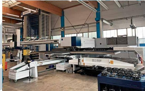
Vollautomatisiertes Blechcenter am Standort Trier
